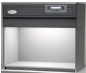
Farbarmusterungskabine ausgestattet mit Diffusor
